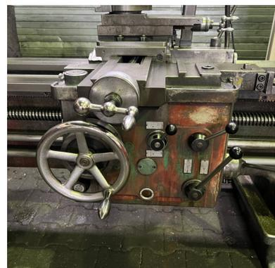
Leit- und Zugspindeldrehmaschine
