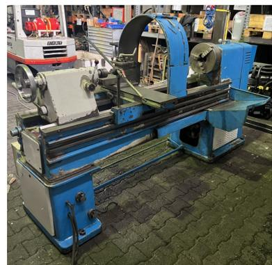
Leit- und Zugspindeldrehmaschine
