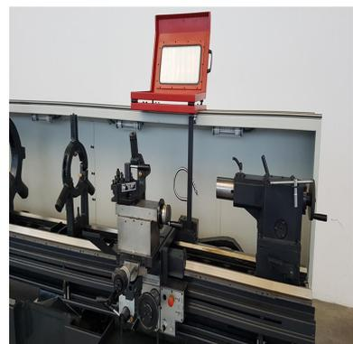
Leit- und Zugspindeldrehmaschine
