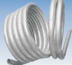
Muster gebogen auf/sample bent with CNC
